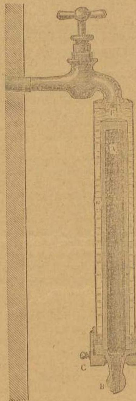
Mediante esta disposição, a agua é filtrada de fora para dentro; as matérias impuras são detidas sobre a superficie exterior da vela que basta tirar e escovar, quando se torna necessaria a sua limpeza.
