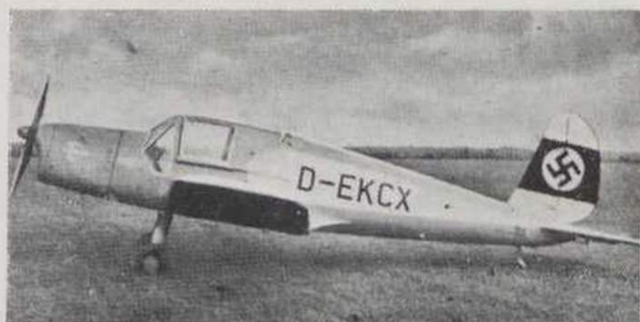
Fig. 174 — Avião de dois lugares para instrução e turismo — Envergadura 10 m ; comprimento 7 m ,60; 1 motor com a potência de 105 C.V. Peso em carga: 830 Kg.; velocidade de cruzeiro: 205 Km./h. à potência de 75 C.V. — distância franqueável 1.025 Km.
