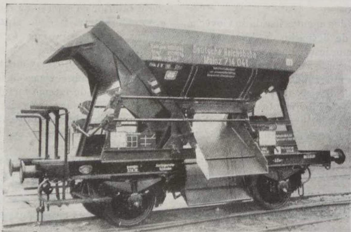
Interessante tipo de vagão especial usado nos Caminhos de Ferro Alemães para transporte e distribuição de balastro. Tem capacidade para 12,5 m 3 de balastro.
