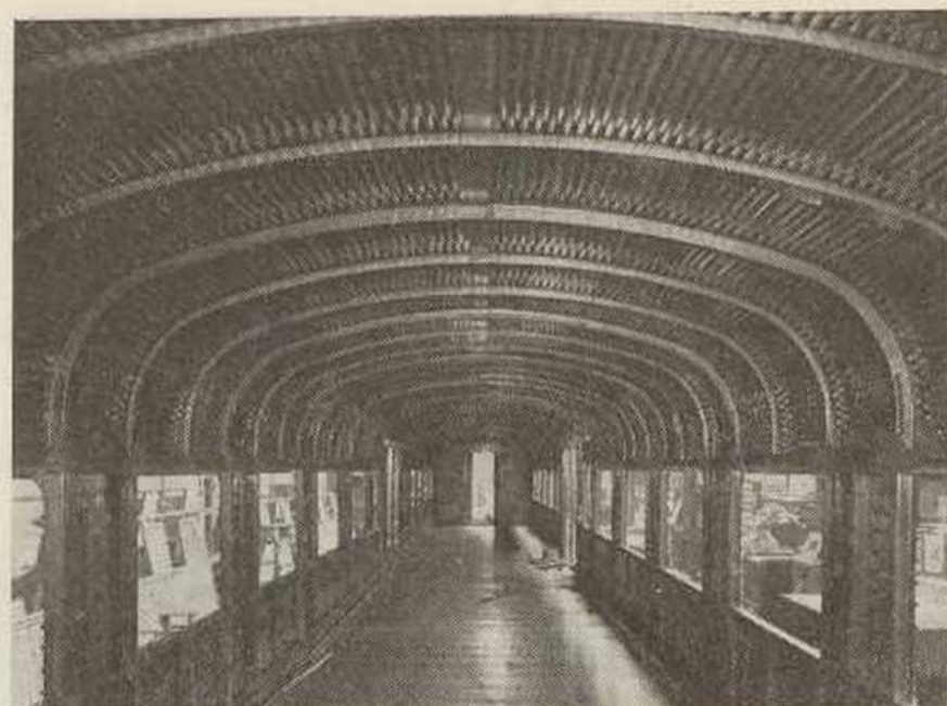
Aspecto do interior da carruagem depois de concluída a soldadura da estrutura principal.
