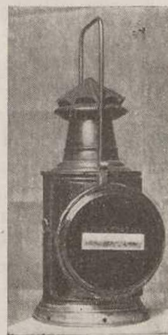
Lanterna de mão para sinais, com o vidro pintado de preto, deixando apenas um pequeno rectângulo para a saída da luz.
