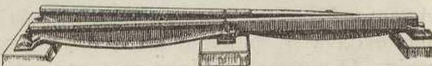
Fig. 9 — Tipo de agulha para o carril de igual resistência
