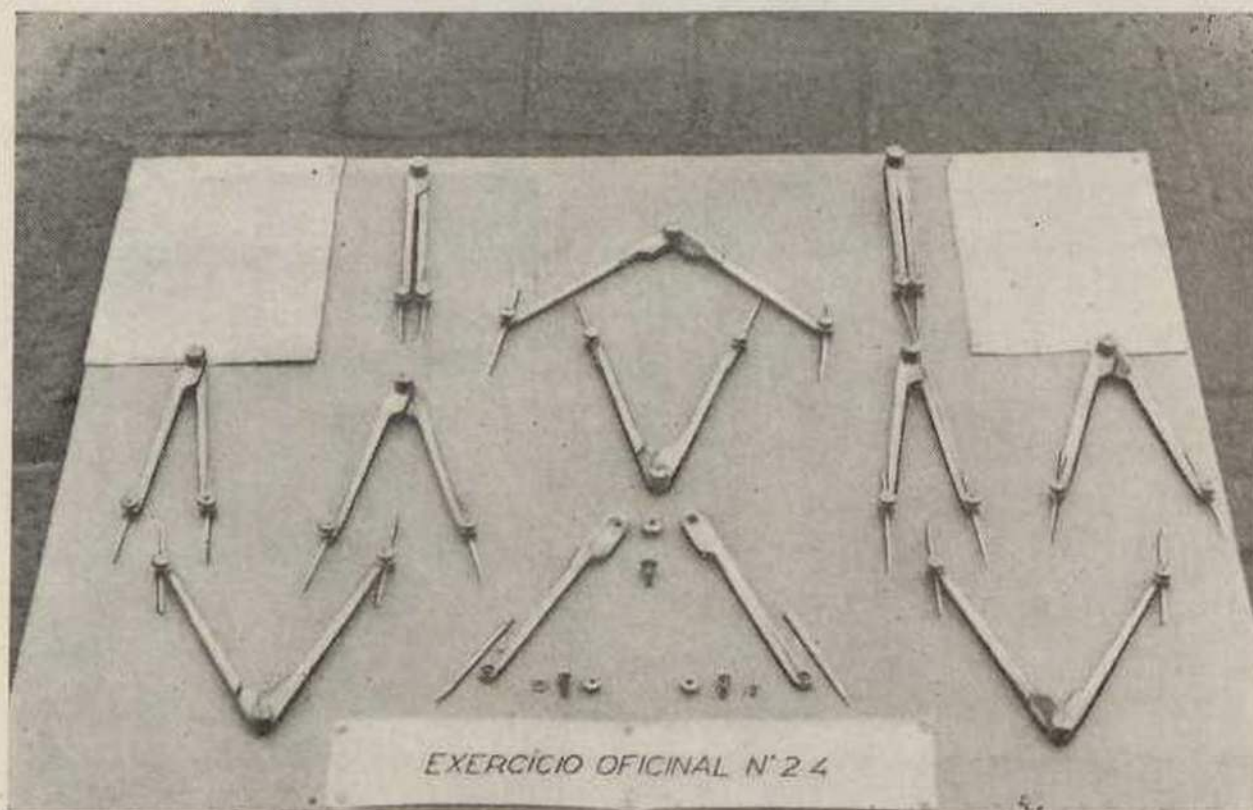
Fig. n.º 3—Outra ferramenta executada no 1.º ano: compasso de círculos
