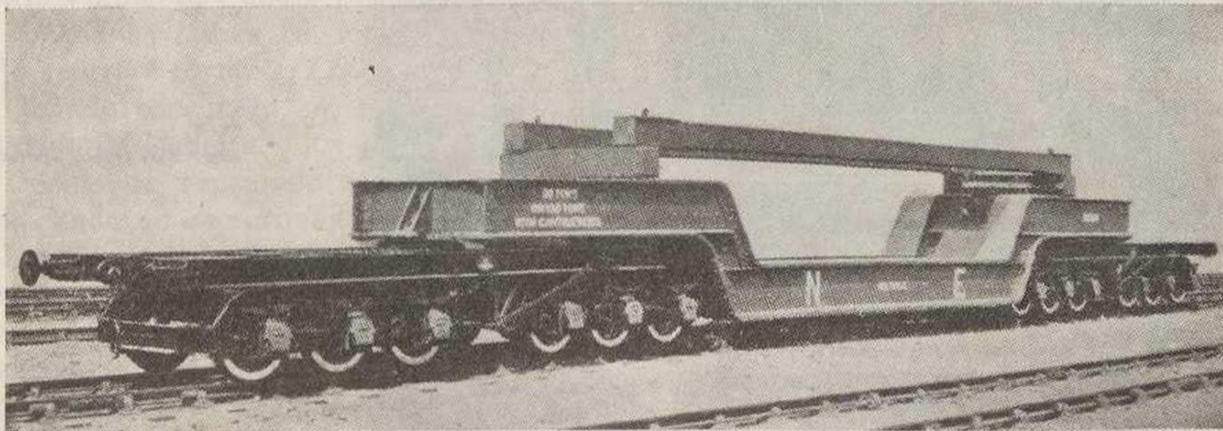
Vagão de tipo especial para 150 toneladas
