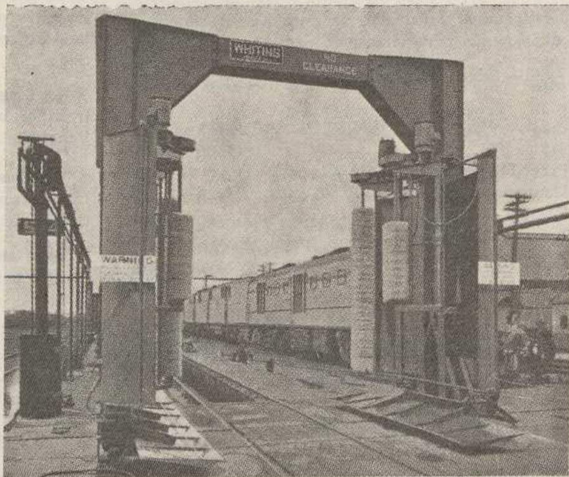
O dispositivo para a lavagem rápida de carruagens.
