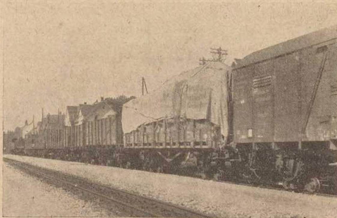
Fig. 2 — O comboio formado por vagões de via normal circulando numa via de bitola inferior
