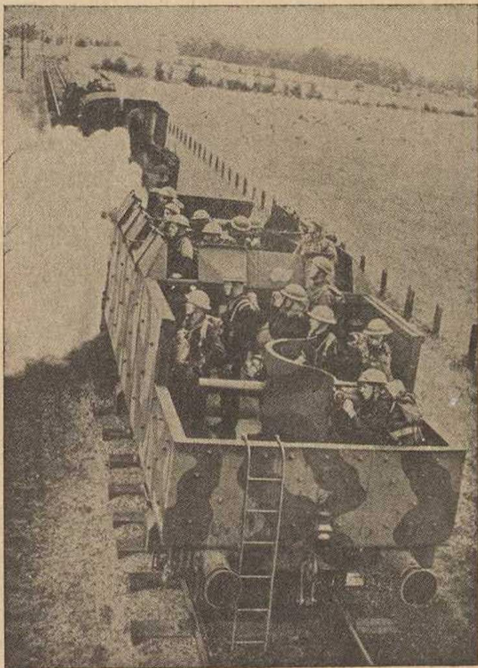
Adaptação de vagão O e locomotivas improvisando 12 comboios blindados
