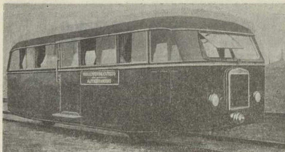
Novo tipo de automotora com rodados pneumáticos
