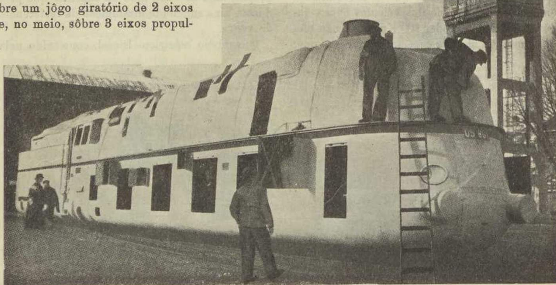
Os últimos retoques. A locomotiva encontra-se totalmente coberta das chapas que lhe dão uma forma aero-dinâmica
