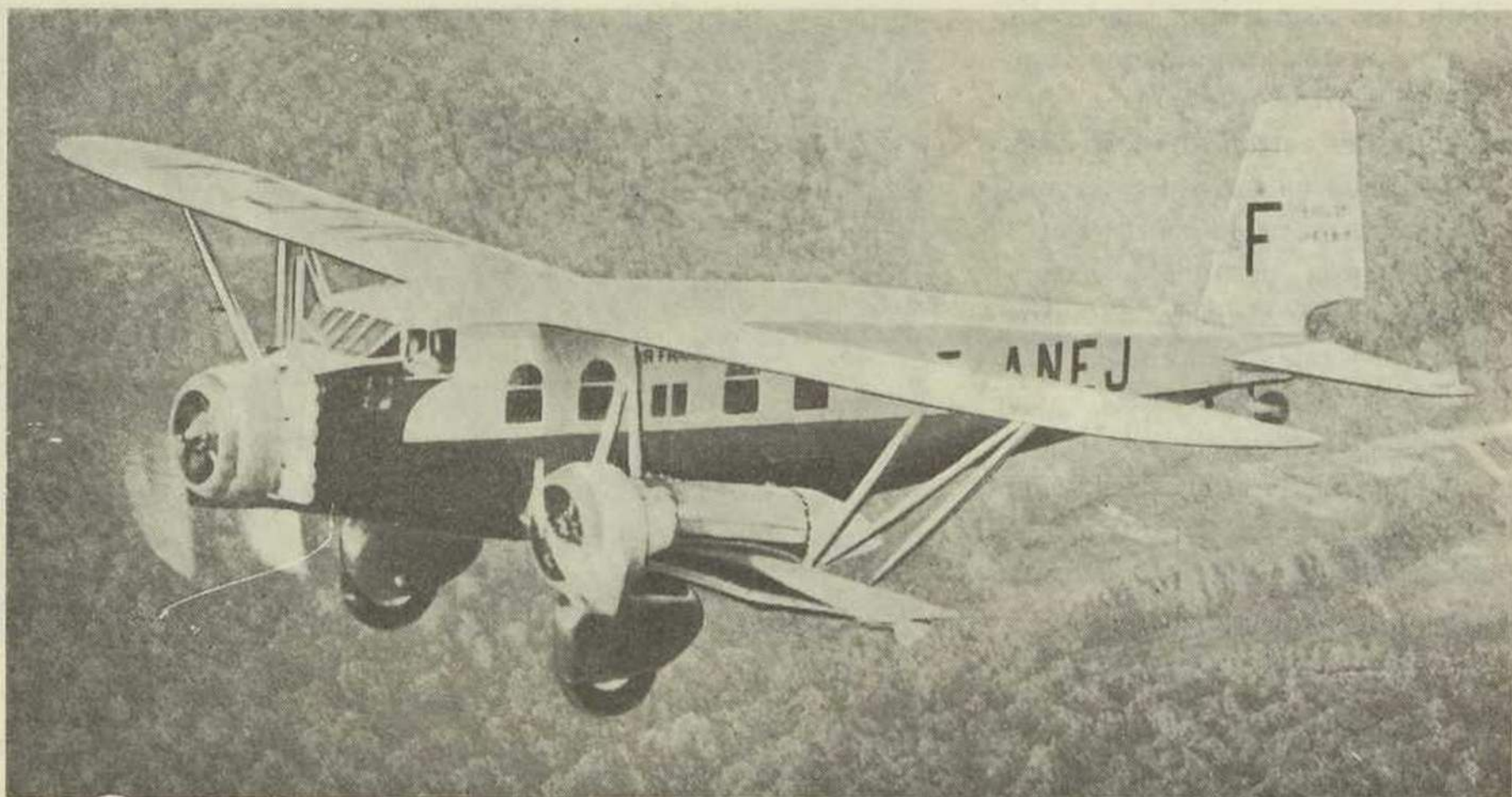
Um «Breguet» trimotor em pleno vôo. Este elegante biplano é todo construído de aço e duralumínio. Tem de envergadura 20,70 e de comprimento 14,60. A velocidade de cruzeiro é de 220 Kms. p. h.. Possui capacidade para 10 passageiros e raio de acção de 1.000 Kms. A «Air-France» utiliza este aparelho nas suas linhas de Marrocos.
