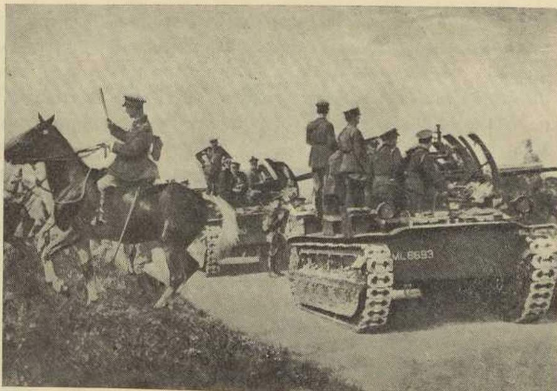
Em cima: Baterias inglesas em manobras. As peças são colocadas sobre plataformas instaladas em tractores, obtendo-se assim uma maior mobilidade no terreno
