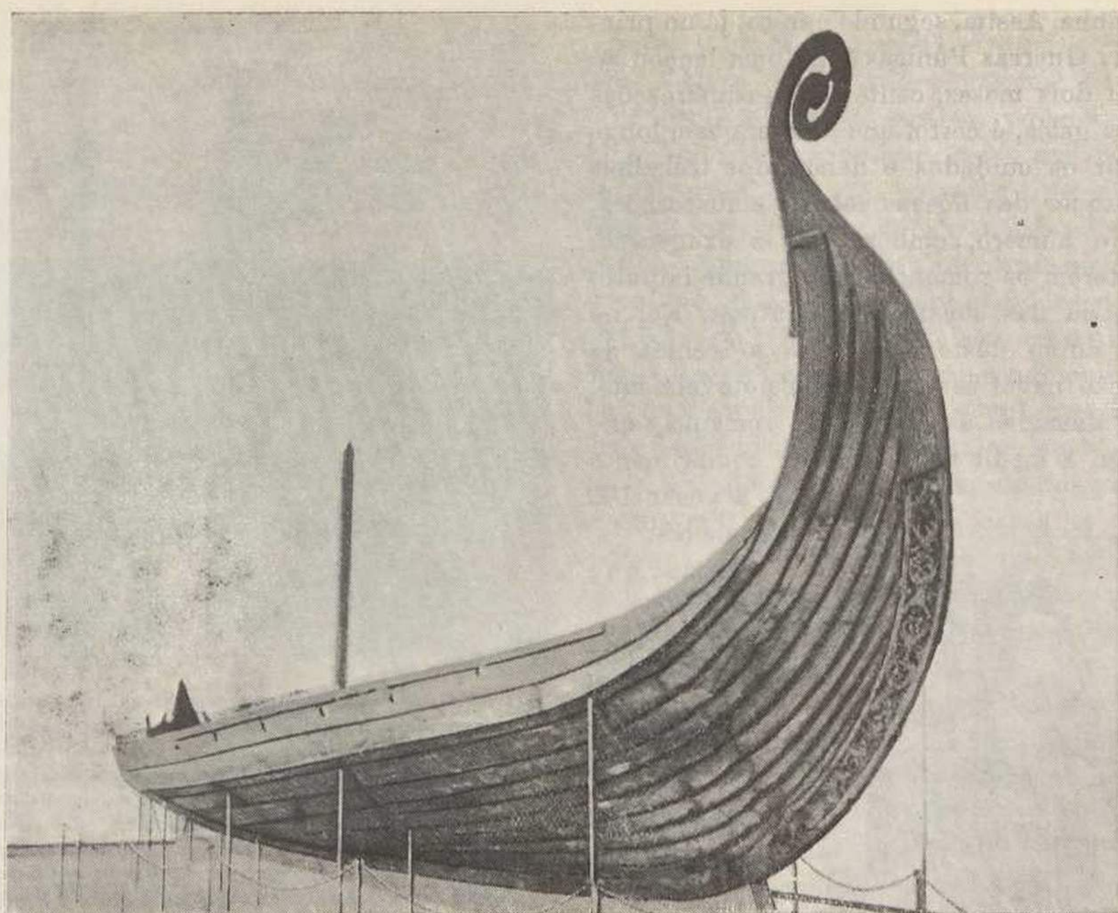
Os navios dos vikings, de linhas elegantes, tinham 20 a 30 metros de comprimento, bastante largos ao meio e a popa e a proa muito elevadas. Foram os primitivos navios de alto mar
