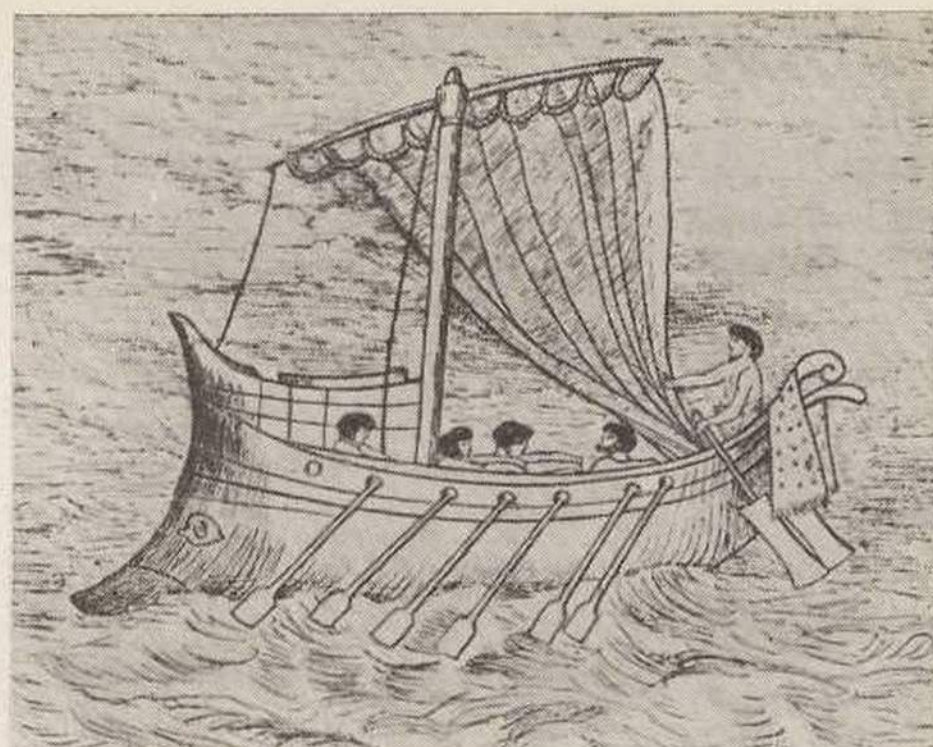
Navio fenício. O timoneiro dirigia a embarcação por meio de dois longos remos. O leme foi inventado no século XII
