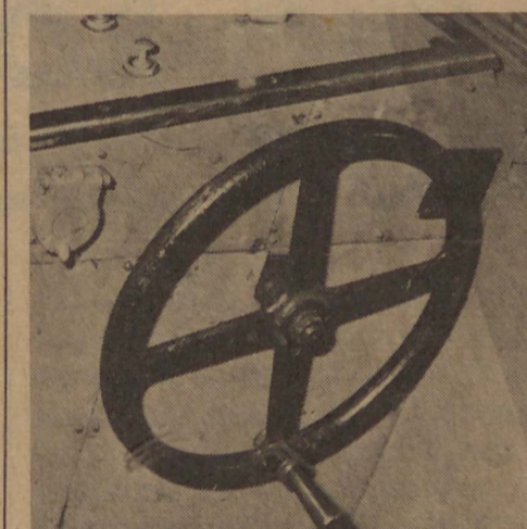
Freio manual, usado para fixação em estacionamento
